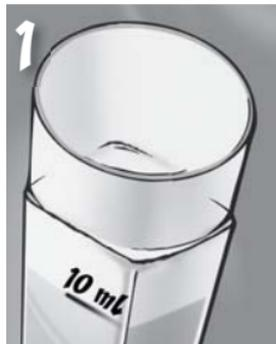
**1.** Riempi con il campione d'acqua il tubo per il test (0106) fino alla linea dei 10 ml.
