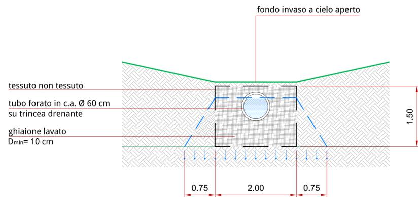
PARTICOLARE D) - Dettaglio scarico di troppo pieno (per i dettagli dimensionali vedasi relazione idraulica)
