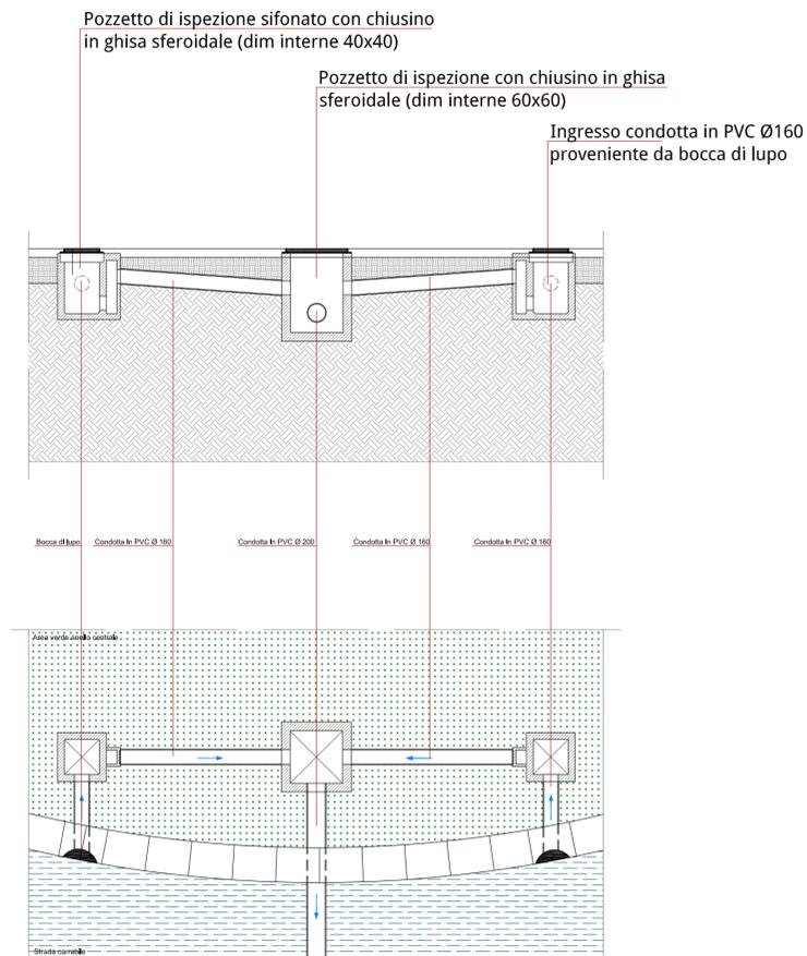
PARTICOLARE B) - Dettaglio smaltimento su SS 13 - innesto caditoie sifonate su pozzetto di ispezione
