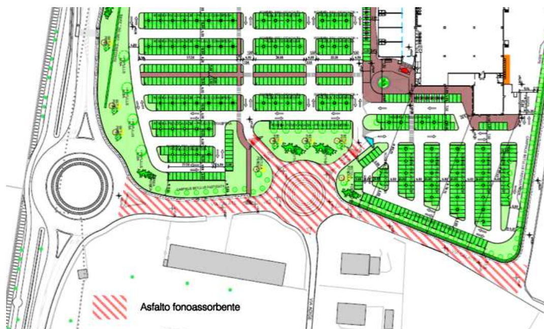
Fig.13 – Estratto di elaborato grafico illustrativo delle tratte interessate da posa di asfalto fonoassorbente.
