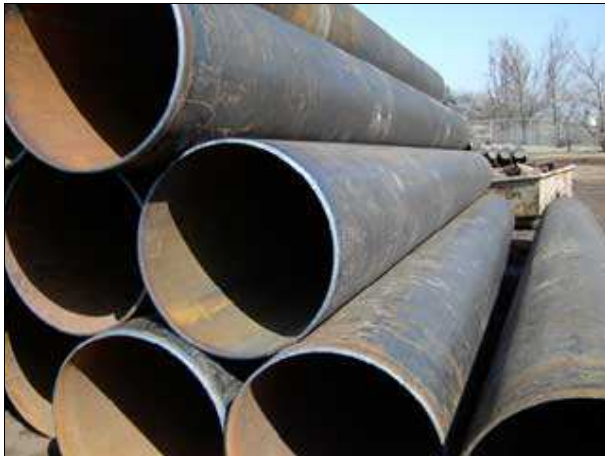
Figura 6 – Vista di tronchi di conductor pipe
