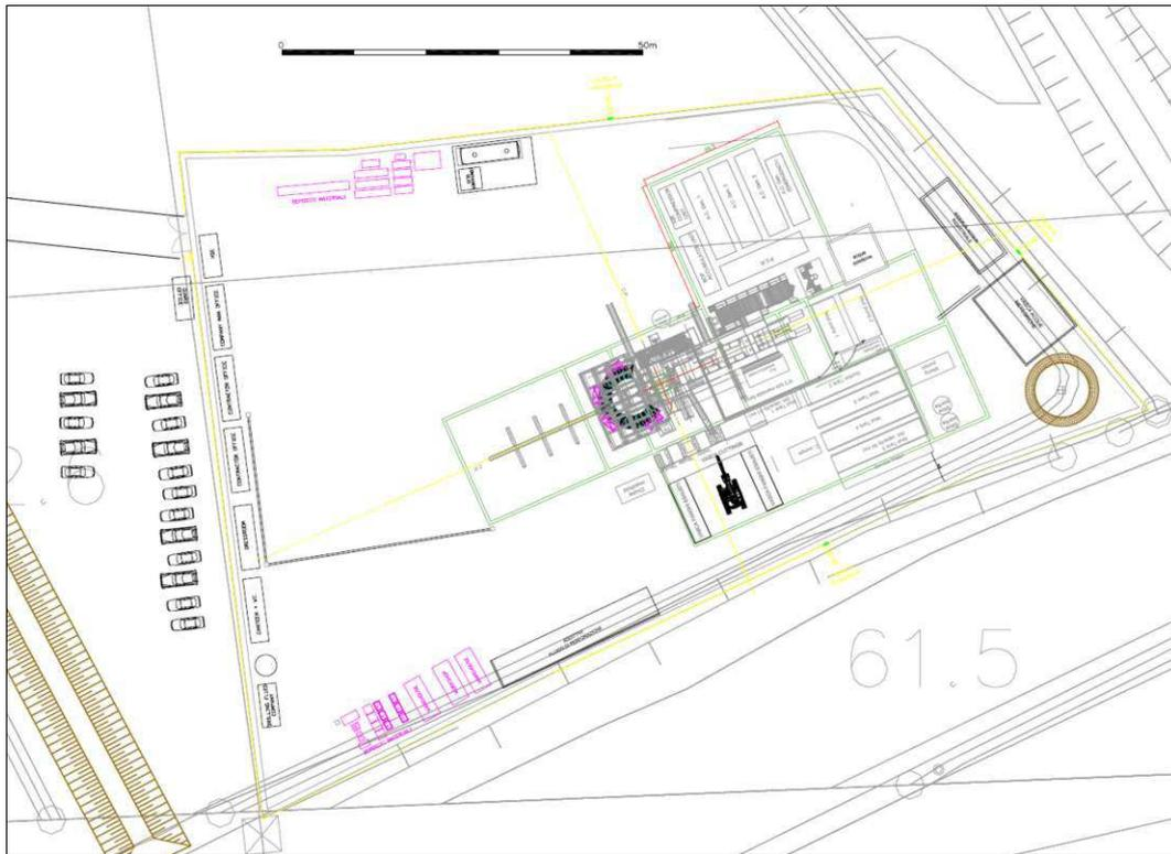
**Figura 4** – Planimetria dell'impianto temporaneo di perforazione
