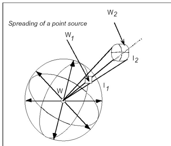
**Figura 16** – Emissione dei raggi di tracciamento
