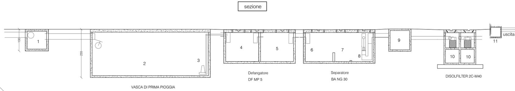
SCHEMA IMPIANTO DI DISOLEAZIONE
