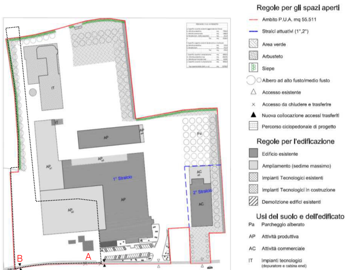
Fig. 20. SUAP in variante - Modifica dell'assetto della Scheda Norma in conseguenza al progetto di ampliamento dell'ambito Colomberotto Spa. L'ampliamento verso est dell'ambito della "scheda norma" è evidenziato con perimetro nero puntinato.
