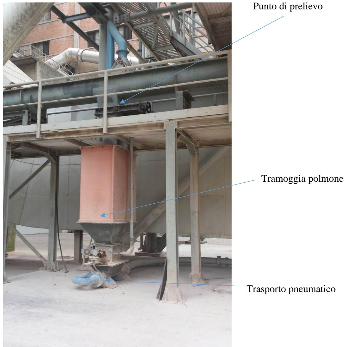
Figura 3: Spillamento polveri da coclea filtro
