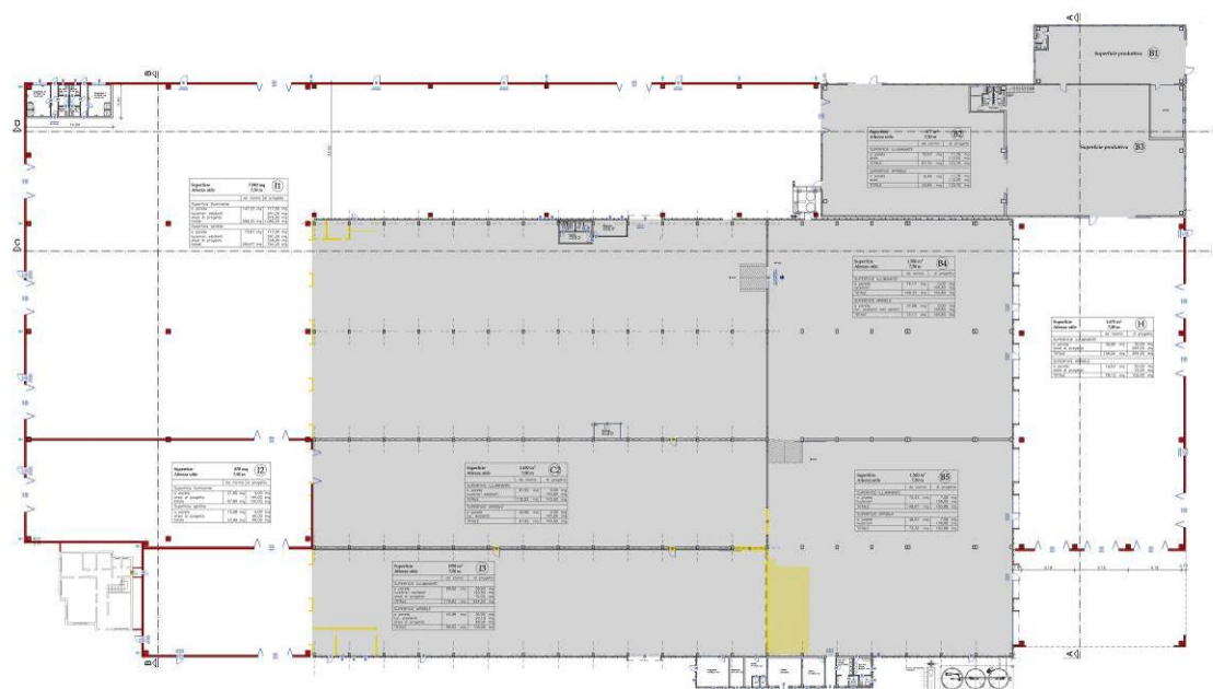
Figura 5 Planimetria dell'ampliamento, in grigio la porzione esistente, in rosso le nuove realizzazioni.
