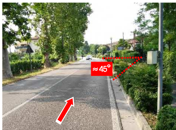
Figura 5.2 – Angolo di installazione dei radar rispetto alla direzione di marcia
