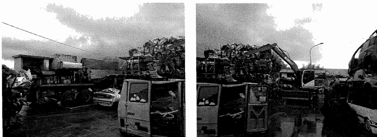
Figura 3-2: Impianto di pressatura e macchinario prelevamento “cubi metallici”
