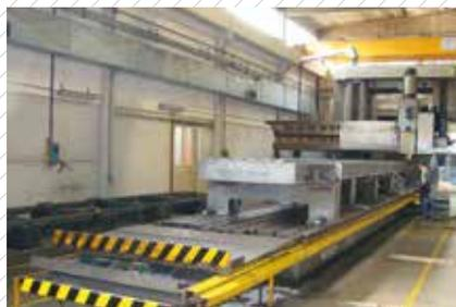
**Fresatura interna della struttura**
