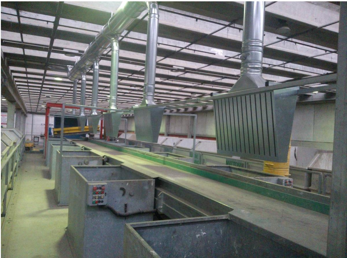
Figura 14 – Foto esempio di cappe aspiranti.
