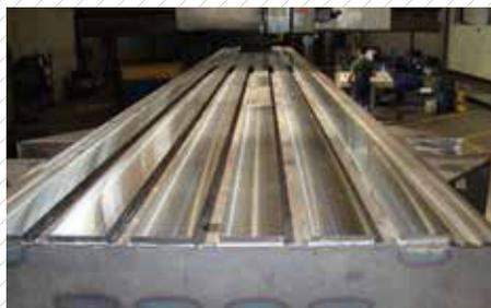
**Fresatura del basamento**
