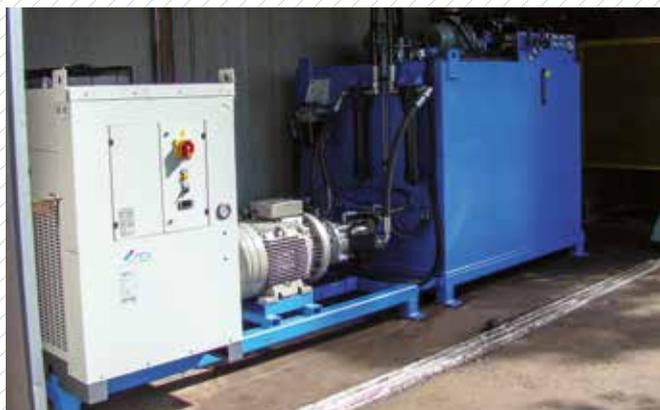
**Centrale idraulica con refrigeratore olio**
