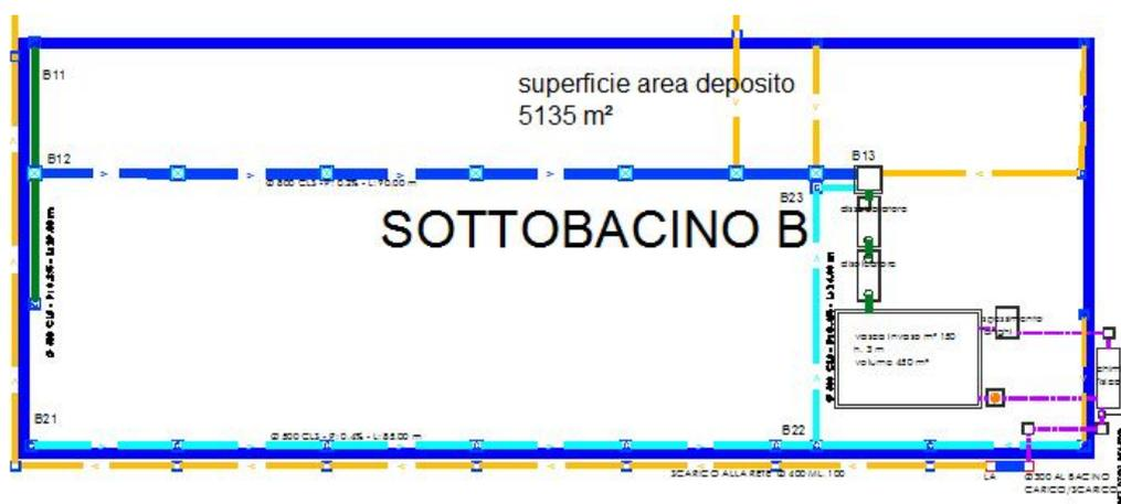
Figura 7 – La disposizione delle condotte e dei manufatti per il trattamento delle acque di dilavamento del sottobacino B
