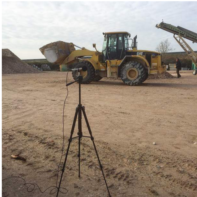
Misurazione attività pala meccanica
