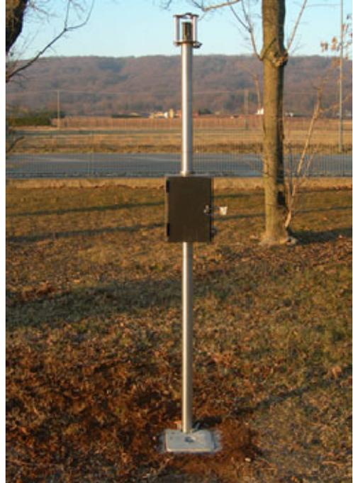
Le misure acquisite verranno verificate e validate attraverso misure freaticometriche manuali da eseguirsi all'atto di sopralluoghi periodici, necessari per lo scarico manuale dei dati memorizzati e per la manutenzione ordinaria della strumentazione.
