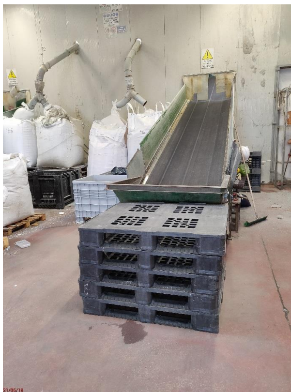
Foto 9 - Nastro trasportatore al mulino di macinazione
