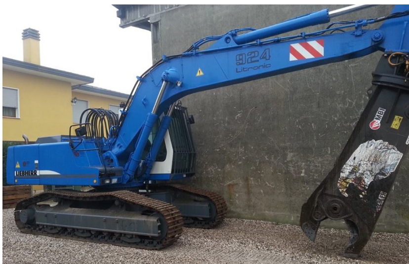
Figura 144 – Immagine esemplificativa dell'escavatore e della pinza-cesoia
