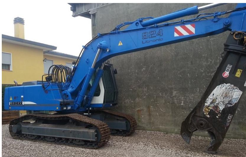
Figura 111 – Immagine esemplificativa dell'escavatore e della pinza-cesoia
