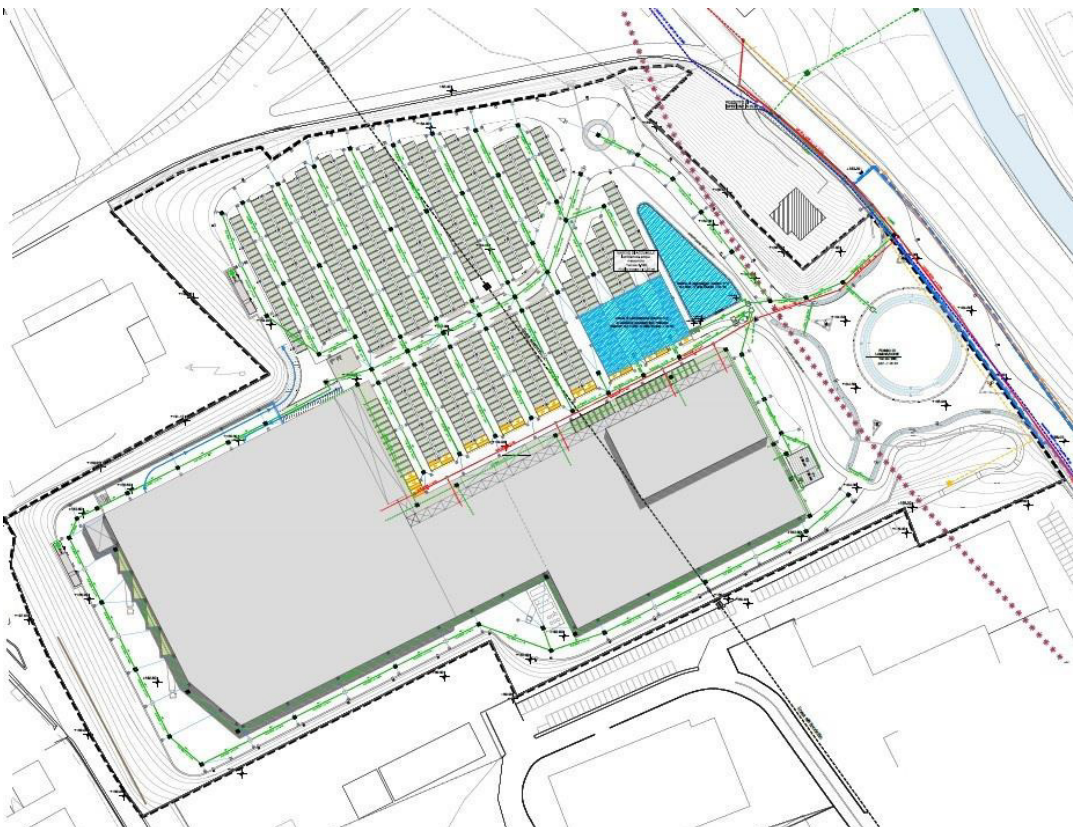
Figura 10 - Proposta di variante al PUA (in verde lo schema fognario per acque meteoriche)
