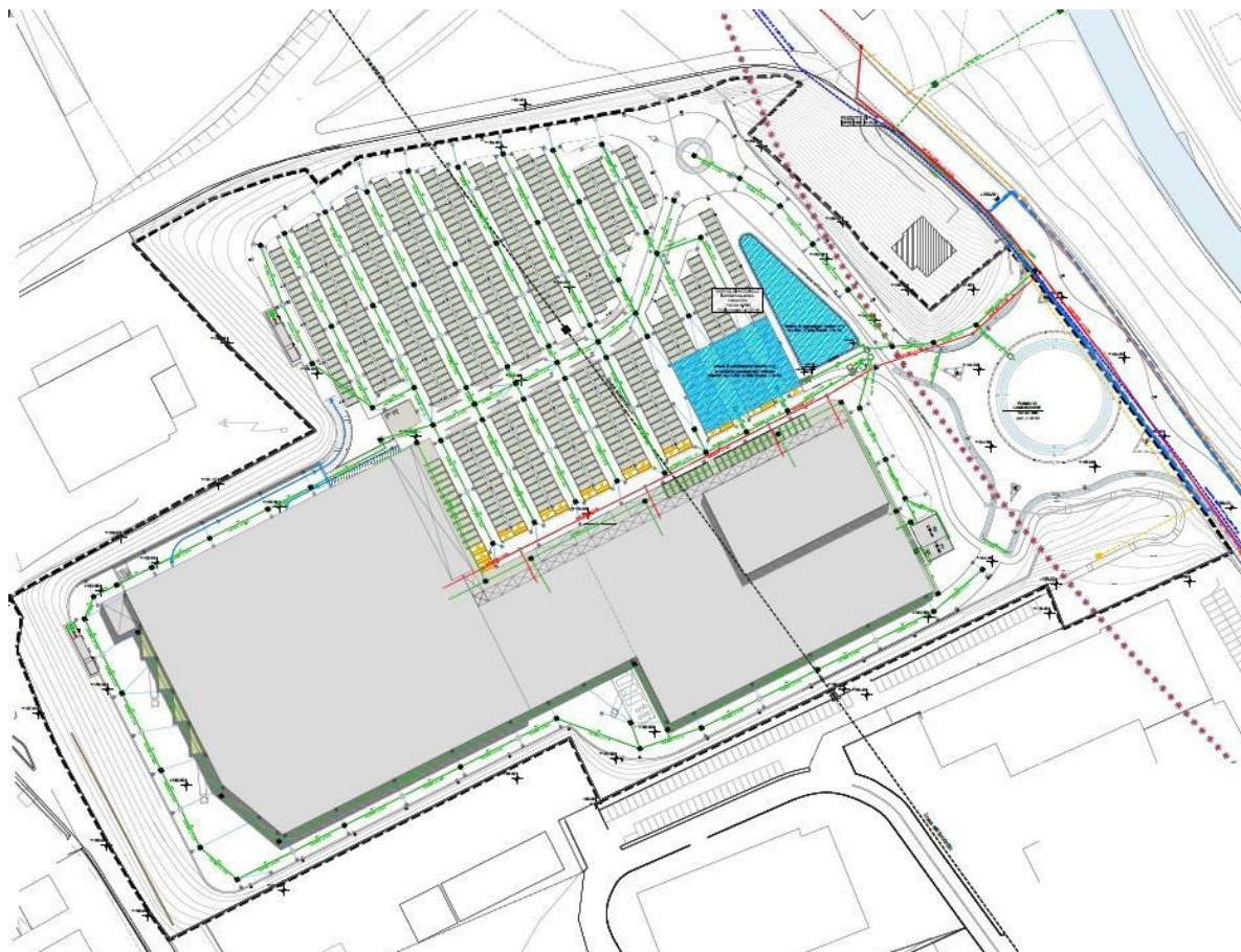
Figura 8 - Proposta di variante al PUA (in verde lo schema fognario per acque meteoriche)
