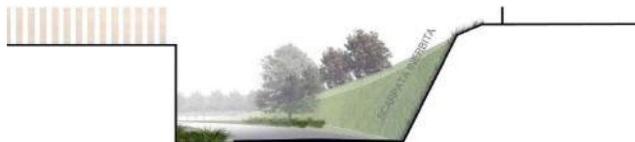
Figura 23: sezione tipo parete chiodata inerbita perimetrale (perimetro sud e Ovest)
