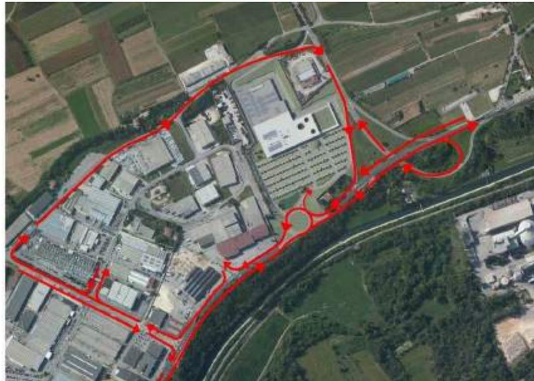
Figura 48: rappresentazione dei flussi di traffico con l'ipotesi della sola svolta a destra per l'accesso su via Cal Lusent ed uscita su via Merlana per i veicoli diretti a nord.
