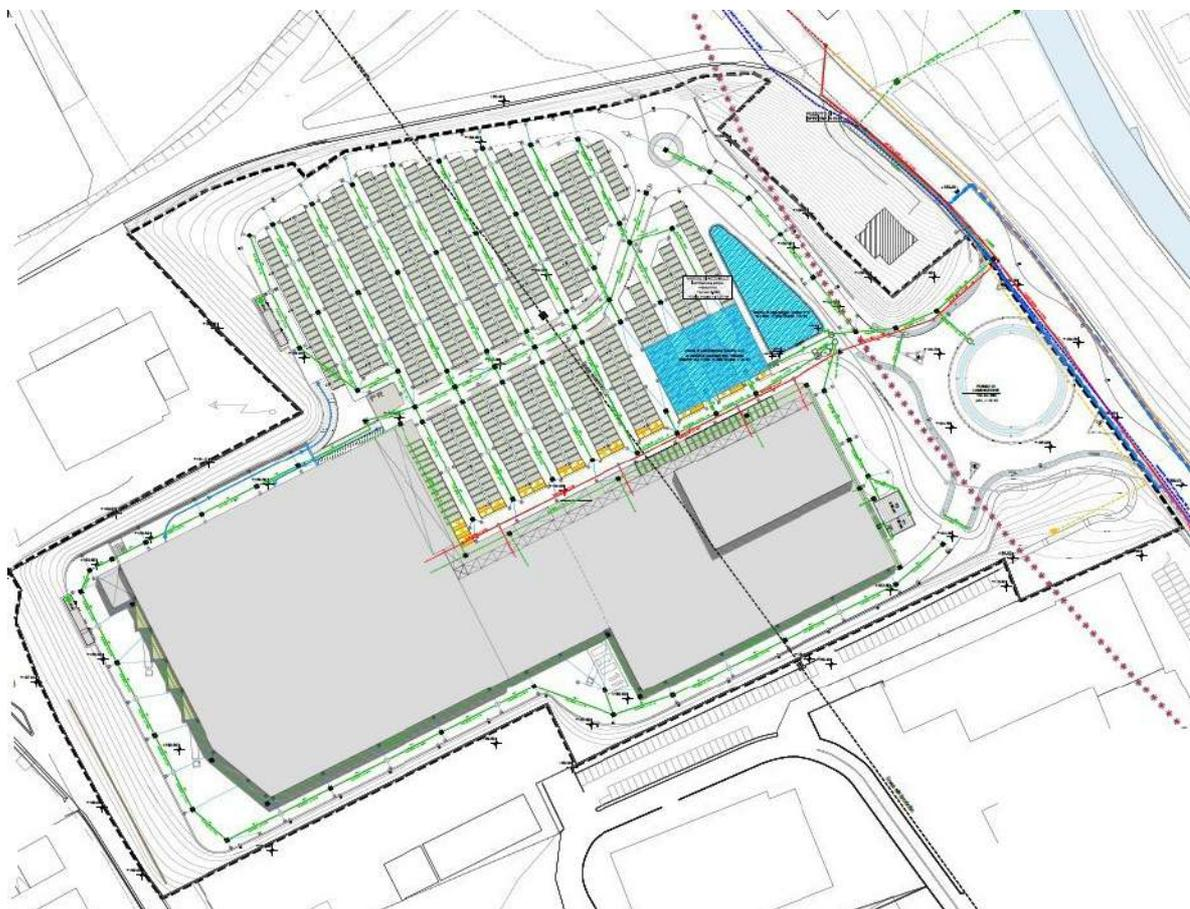
**Figura 8** - variante al progetto (in verde lo schema fognario per acque meteoriche)
