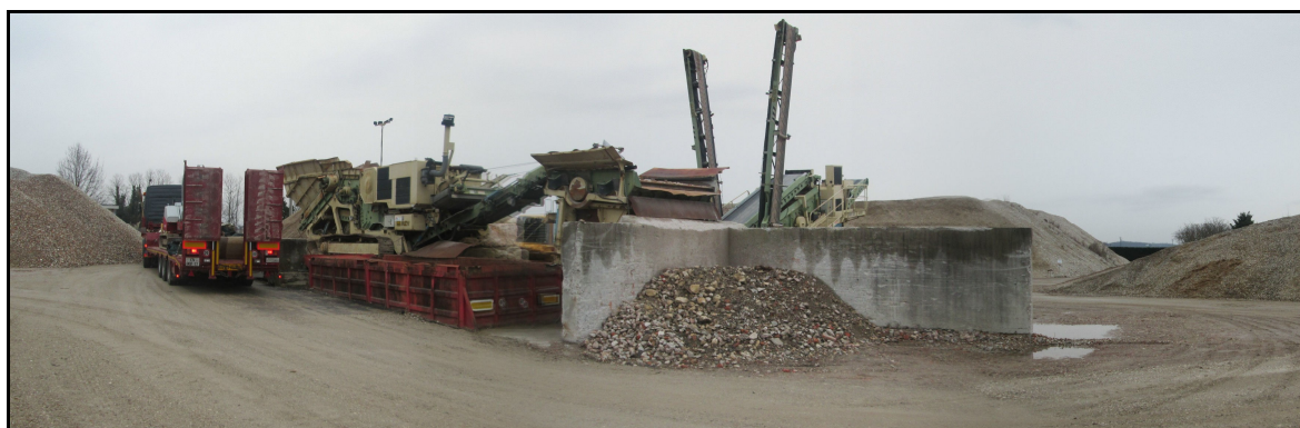
Foto 5: Impiantistica: il frantoio sulla sinistra e l'unità mobile di vagliatura dietro il muro di delimitazione
