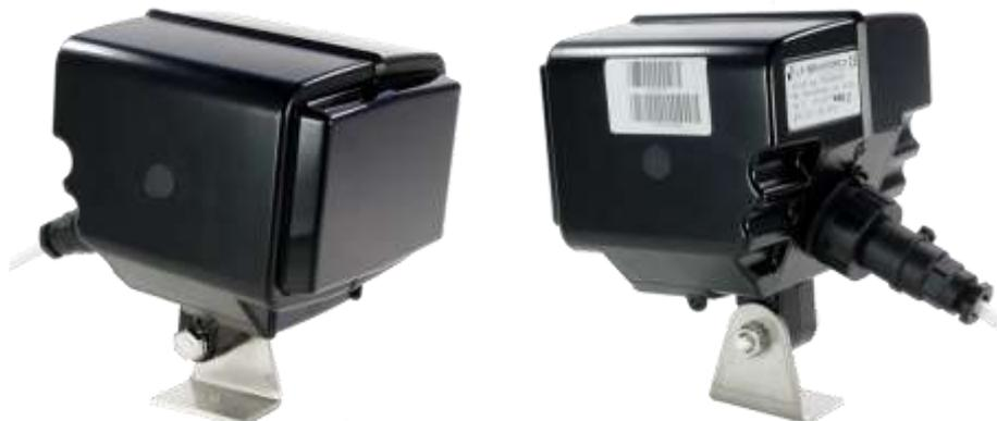
Ad alta tecnologia I radar SPOT utilizzano il Principio Doppler Fizeau in 24.125 GHz (banda K). Grazie a questa banda ad alta frequenza, I risultati del rilevamento dei radar SPOT sono pienamente efficaci e affidabili.
