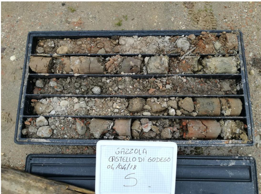
Foto 4 sondaggio S centro da 0 a 5 m
