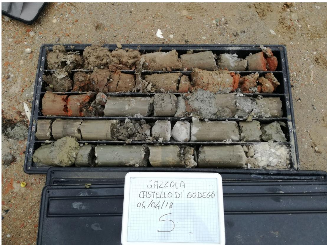
Foto 5 sondaggio S centro da 5 a 10 m
