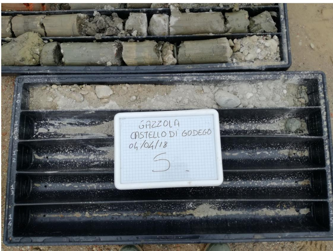
Foto 6 sondaggio S centro da 10 a 11 m
