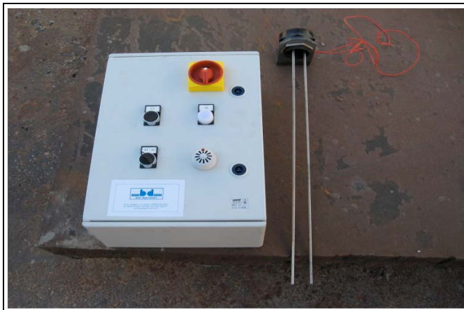
Quadro elettrico e sonde rilevamento oli
