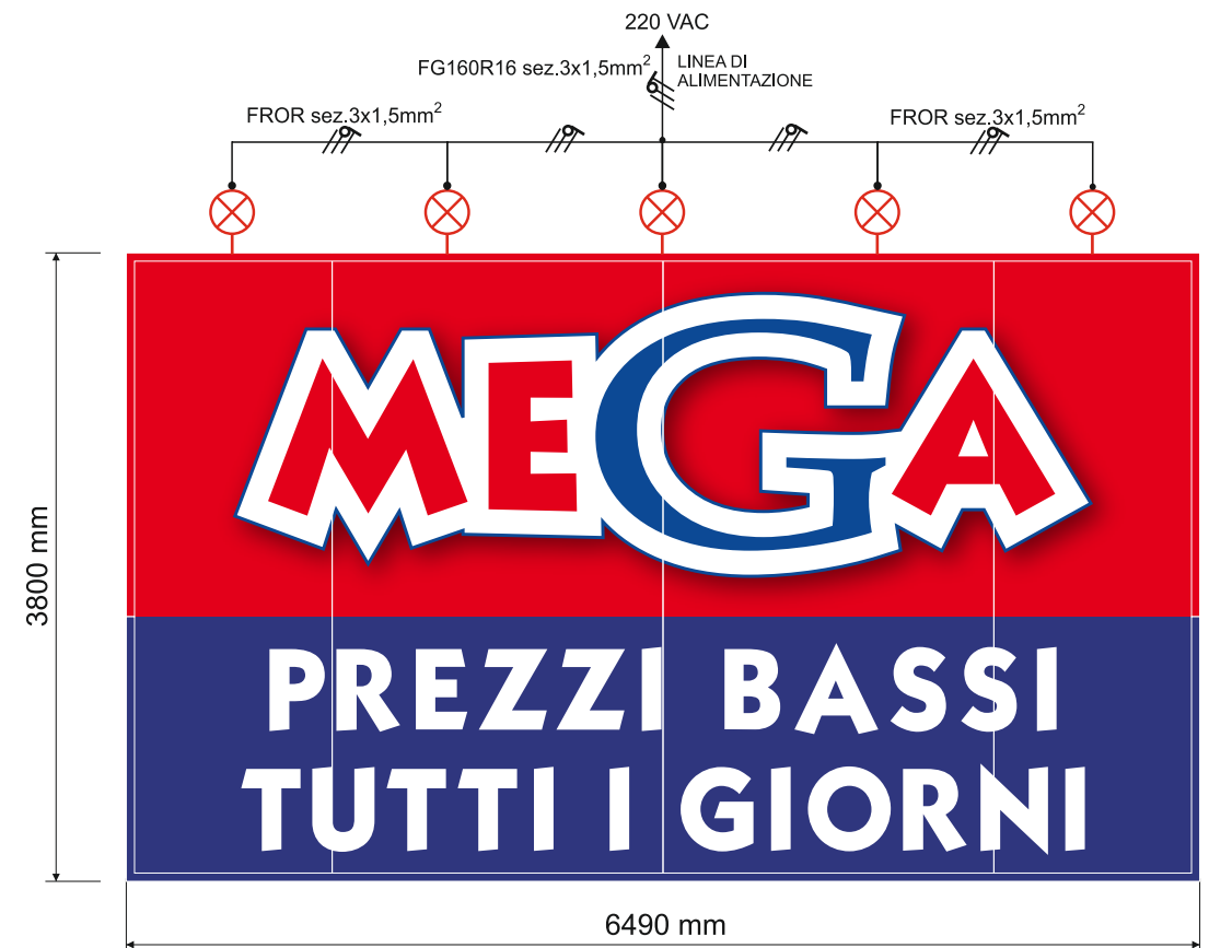
VISTA FRONTALE PANNELLO INGRESSO SECONDARIO (LATO SUD)
