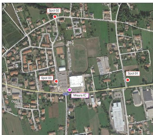
Presso le posizioni "Spot 01", "Spot 02", e "Spot 03" sono stati eseguiti rilievi a campionamento in periodo diurno, ad un'altezza dal piano campagna di 1,5 m, della durata di 30 minuti ciascuno, mentre in corrispondenza alla posizione "Misura IC" è stato effettuato un rilievo ad integrazione continua, nei periodi diurno e notturno, ponendo il fonometro ad un'altezza di 4 m dal suolo.
