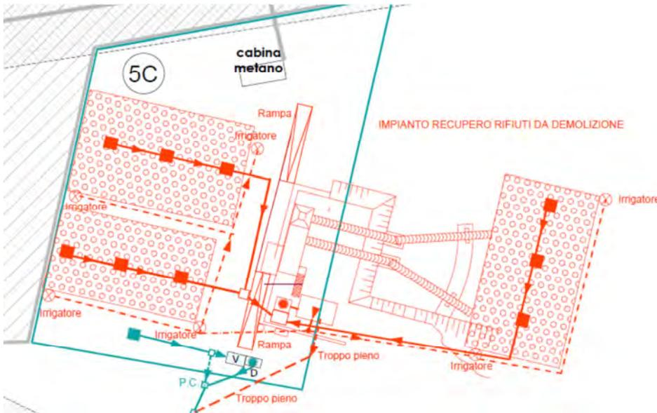
**Figura 5.2. Sistema di raccolta acque nella nuova area di posizionamento dell'impianto di recupero rifiuti**
