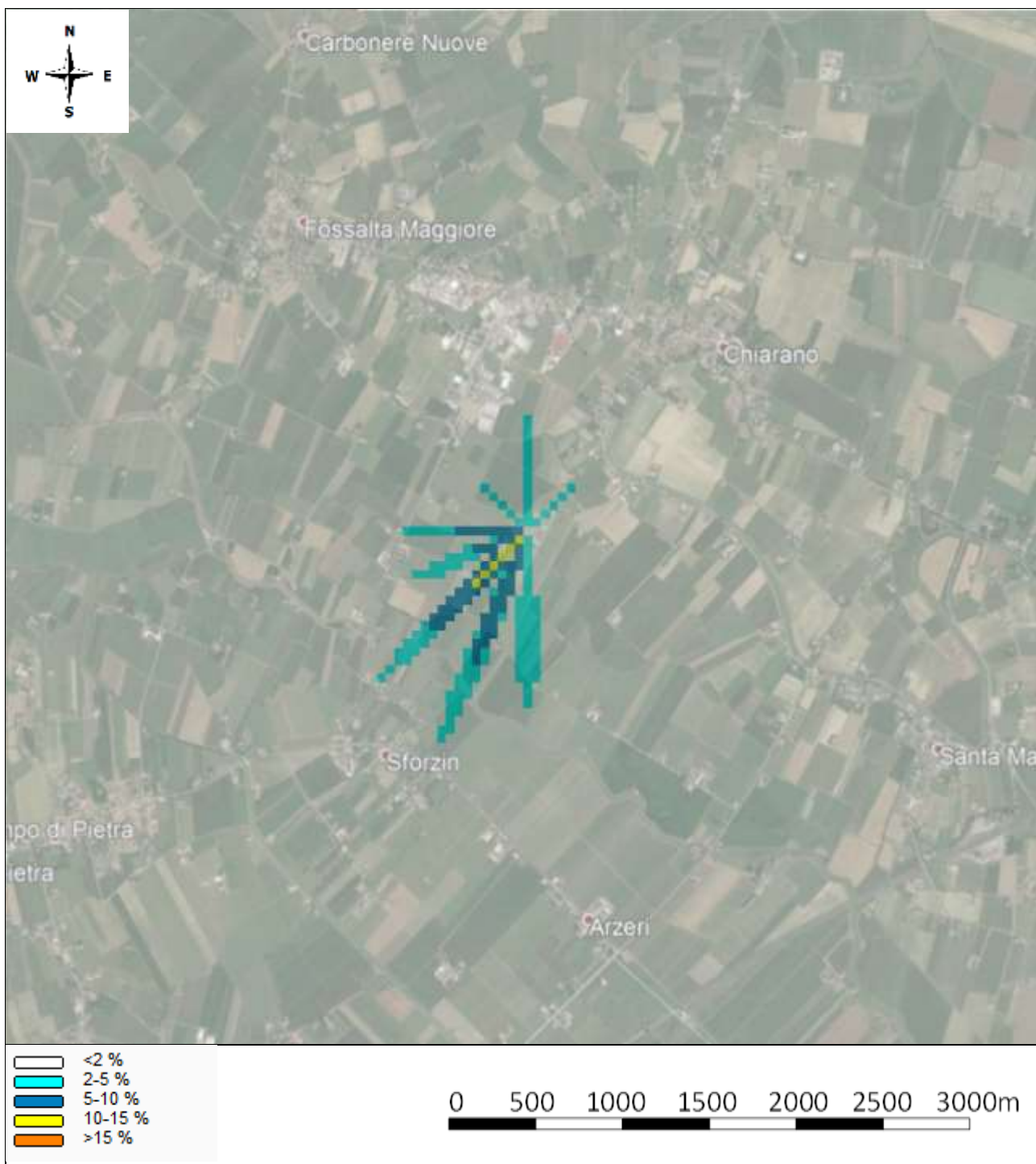
Figura 9 - Mappa della percentuale di tempo-sopra-soglia: percentuale del tempo dell'intera simulazione (1 anno) in cui l'odore supera, per ciascuna cella, la soglia prestabilita ( 3 \text{ OU/m}^3 ), per le condizioni previste nel progetto con emissione puntiforme da una fonte, nella situazione pre-ampliamento dell'allevamento avicolo. Il 98° percentile è indicato dal confine tra l'azzurro e il bianco (Tss<2%).
