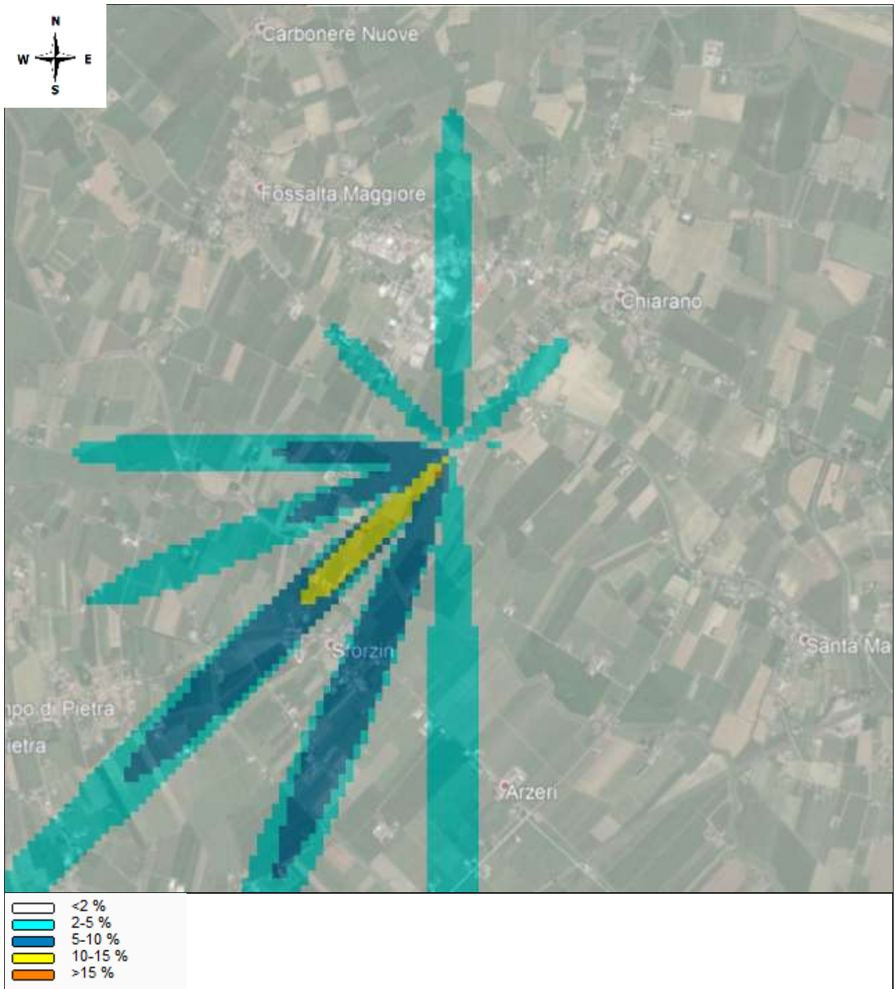
Figura 8 - Mappa della percentuale di tempo-sopra-soglia : percentuale del tempo dell'intera simulazione (1 anno) in cui l'odore supera, per ciascuna cella, la soglia prestabilita ( 1 \text{ OU/m}^3 ), per le condizioni previste nel progetto con emissioni puntiforme da una fonte, nella situazione post-ampliamento dell'allevamento avicolo. Il 98° percentile è indicato dal confine tra l'azzurro e il bianco ( Tss<2% ).
