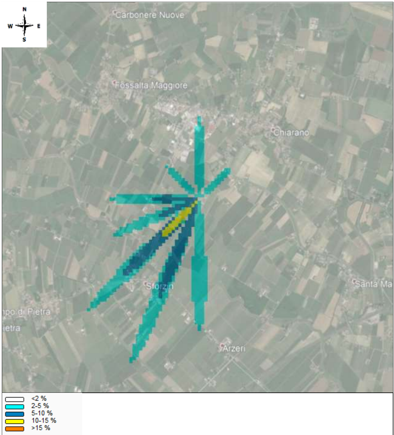
Figura 7 - Mappa della percentuale di tempo-sopra-soglia : percentuale del tempo dell'intera simulazione (1 anno) in cui l'odore supera, per ciascuna cella, la soglia prestabilita (1 OU/m 3 ), per le condizioni previste nel progetto con emissioni puntiforme da una fonte, nella situazione pre-ampliamento dell'allevamento avicolo. Il 98° percentile è indicato dal confine tra l'azzurro e il bianco ( Tss<2% ).
