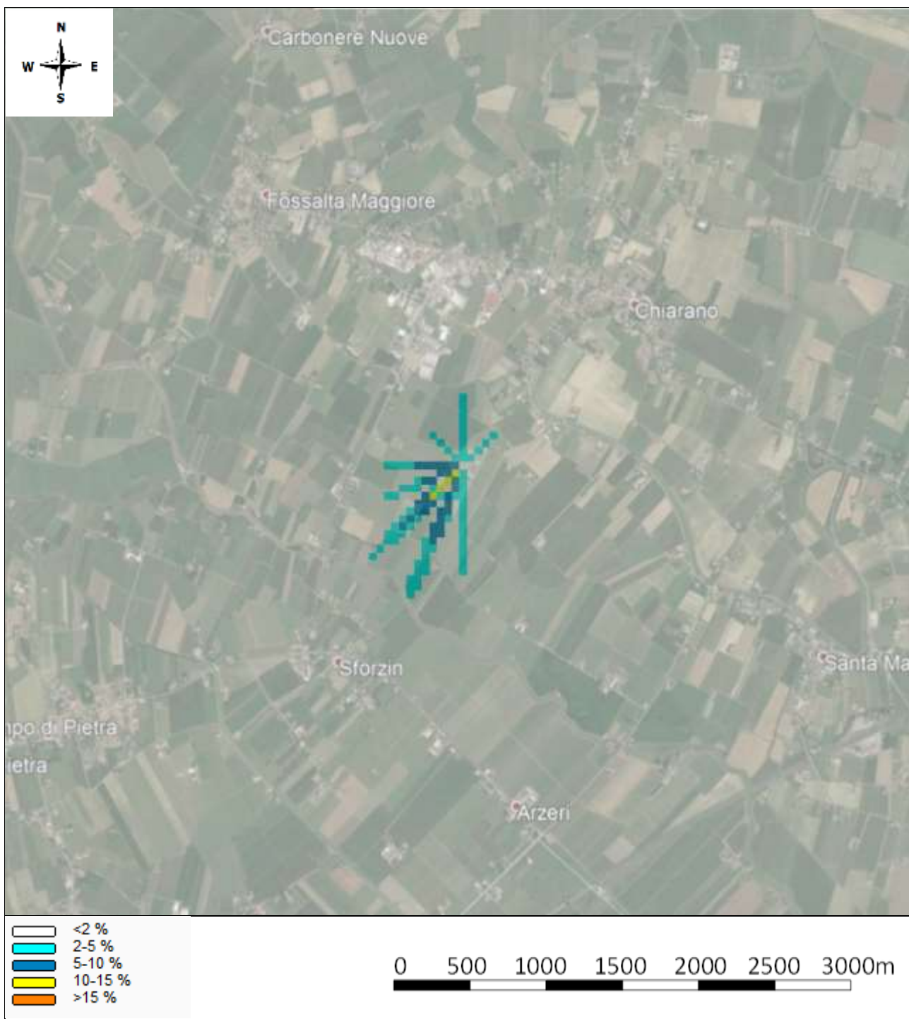
Figura 11 - Mappa della percentuale di tempo-sopra-soglia: percentuale del tempo dell'intera simulazione (1 anno) in cui l'odore supera, per ciascuna cella, la soglia prestabilita ( 5 \text{ OU/m}^3 ), per le condizioni previste nel progetto con emissione puntiforme da una fonte, nella situazione pre-ampliamento dell'allevamento avicolo. Il 98° percentile è indicato dal confine tra l'azzurro e il bianco ( T_{ss}<2\% ).
