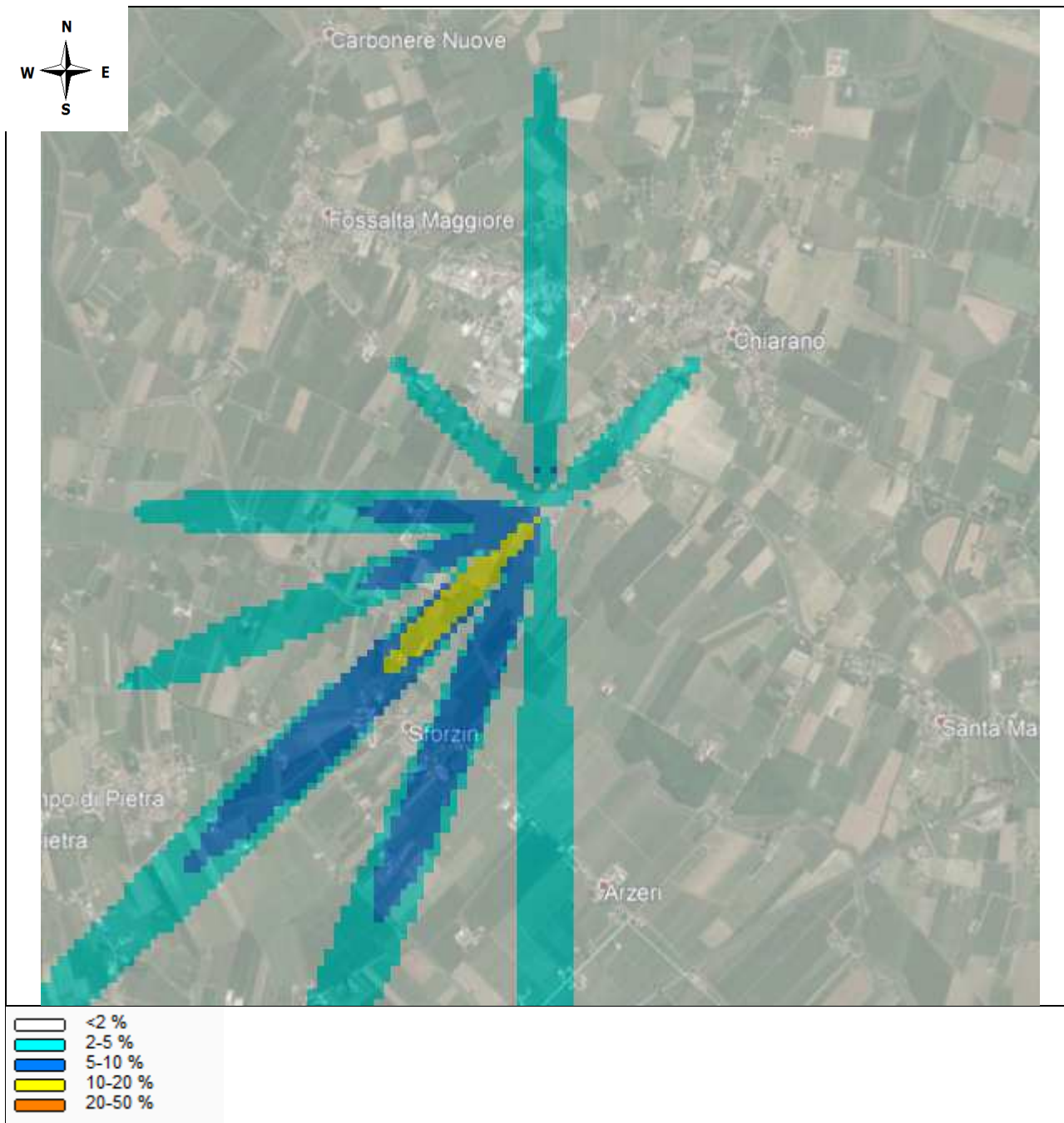
Figura 10 - Mappa della percentuale di tempo-sopra-soglia : percentuale del tempo dell'intera simulazione (2 anni) in cui l'odore supera, per ciascuna cella, la soglia prestabilita ( 1 \text{ OU/m}^3 ), per le condizioni previste nel progetto con emissione puntiforme da una fonte, nella situazione post-ampliamento dell'allevamento avicolo. Il 98° percentile è indicato dal confine tra l'azzurro e il bianco ( Tss<2% ).
