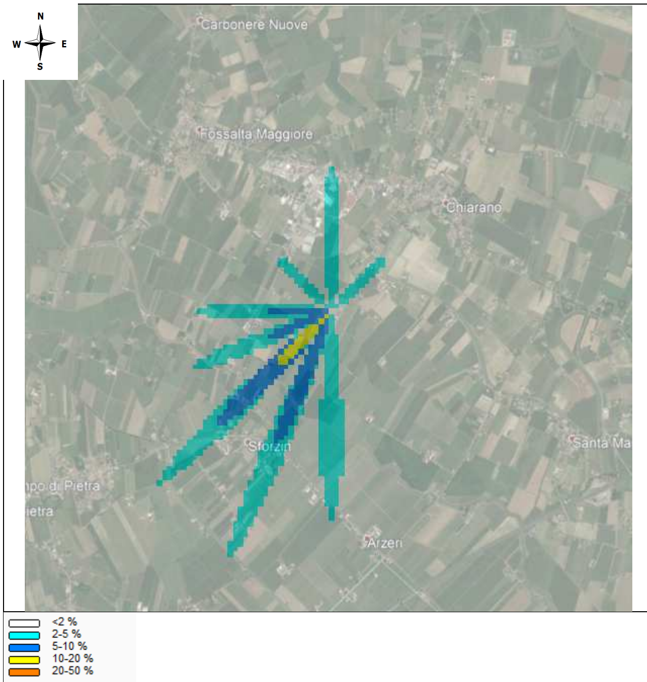
Figura 9 - Mappa della percentuale di tempo-sopra-soglia : percentuale del tempo dell'intera simulazione (2 anni) in cui l'odore supera, per ciascuna cella, la soglia prestabilita ( 1 \text{ OU/m}^3 ), per le condizioni previste nel progetto con emissione puntiforme da una fonte, nella situazione pre-ampliamento dell'allevamento avicolo. Il 98° percentile è indicato dal confine tra l'azzurro e il bianco ( Tss<2% ).
