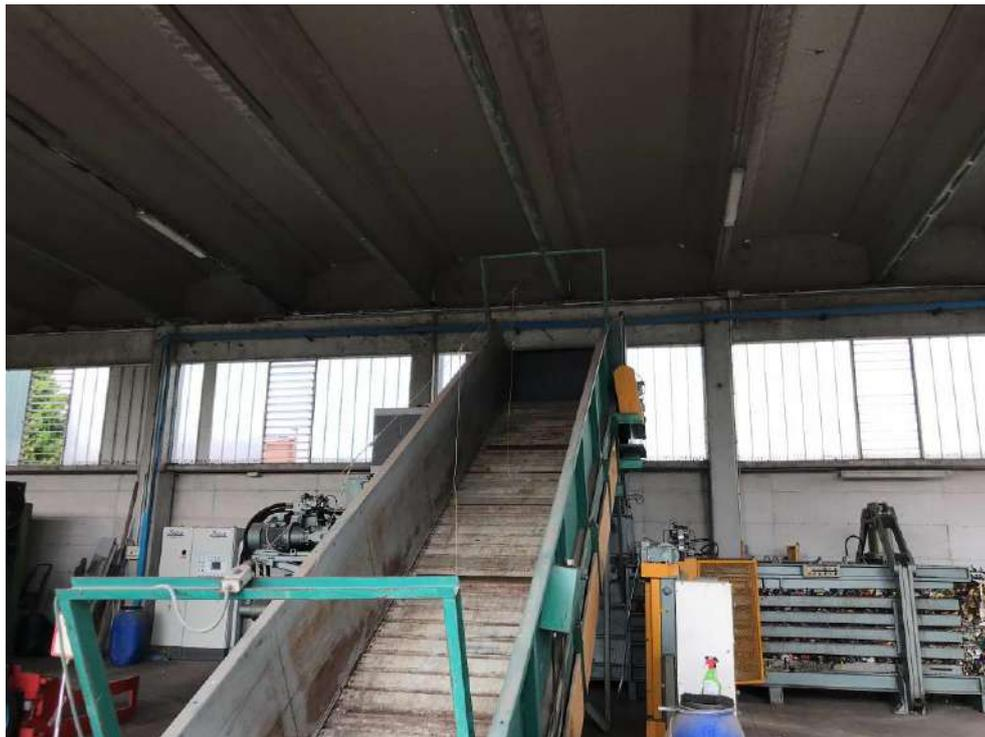
**Foto 15** - Nastro caricatore e pressa oleodinamica
