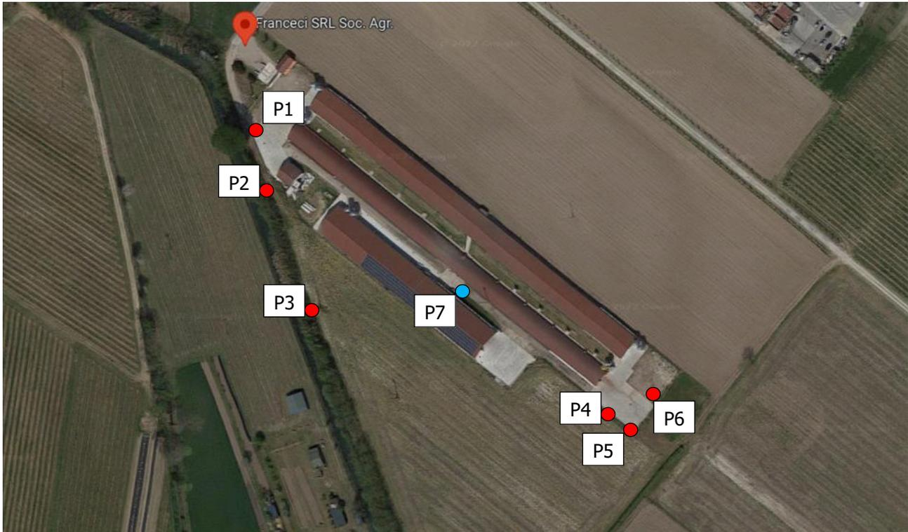
**Figura 6 – Immagine satellitare della zona con indicati i punti in cui è stato eseguito il rilievo fonometrico del rumore ambientale (in rosso punti al confine, in blu punti di misura davanti ai nuovi ventilatori)**
