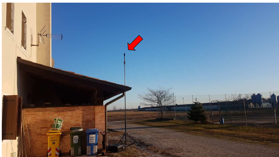
Figura 4 – Immagini del posizionamento del microfono per la misura di 24 ore
