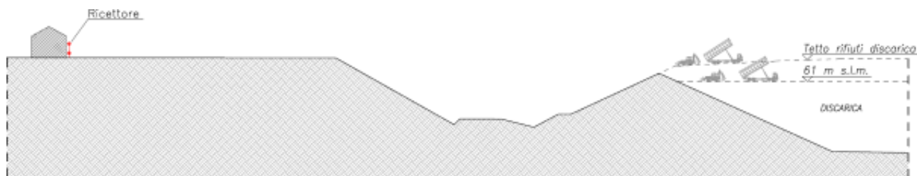
Figura 5 – Schema posizione macchinari in seguito all'avanzamento dei lavori
