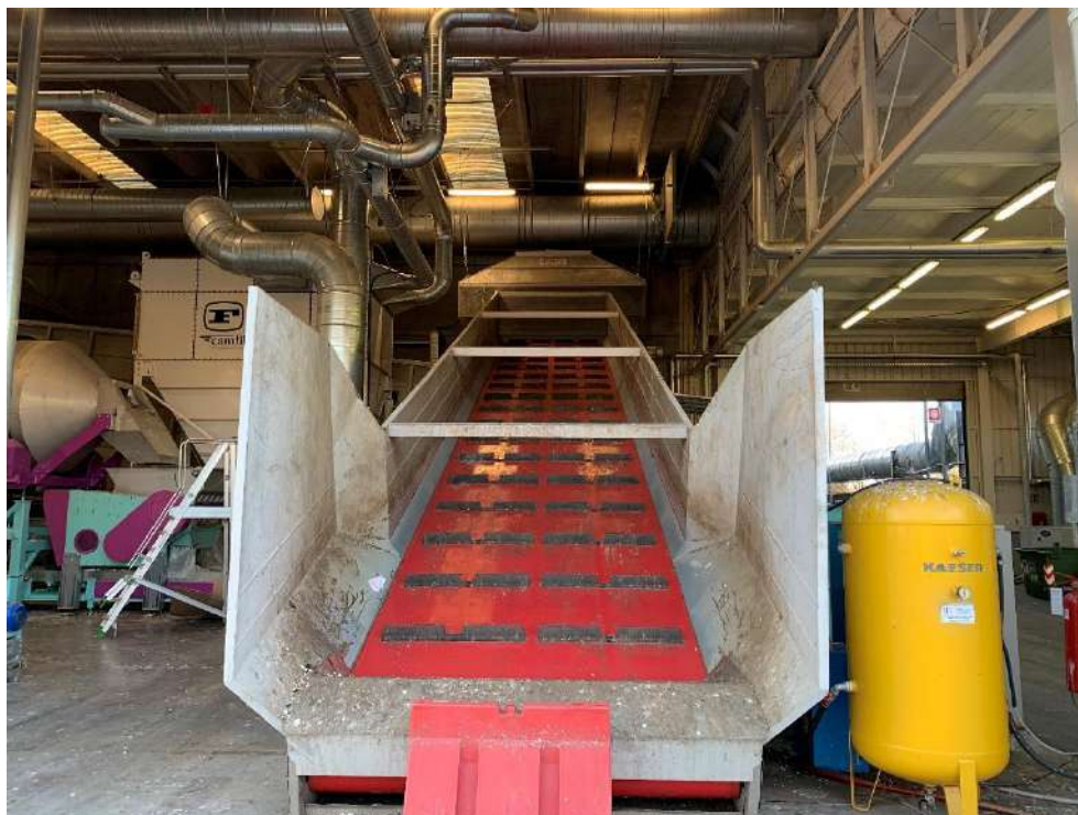
Fotografia 21 – Vista nastro di carico rifiuti PAP (alimentazione impianto)
