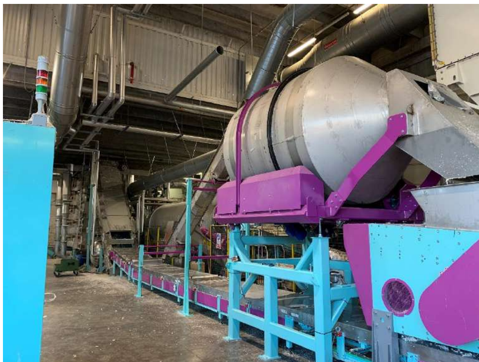
Fotografia 22 – Vista sezione di sterilizzazione impianto PAP
