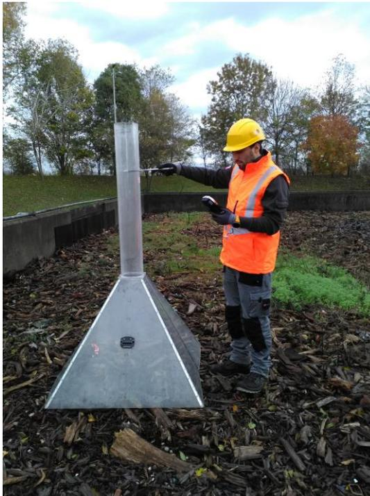
Figura 4: Mappatura dei parametri e campionamento sulla superficie del biofiltro.
