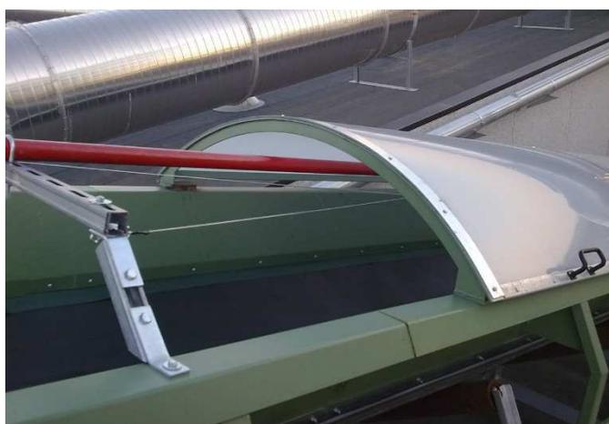
**Figura 2.** Esempio di copertura dei nastri trasportatori
