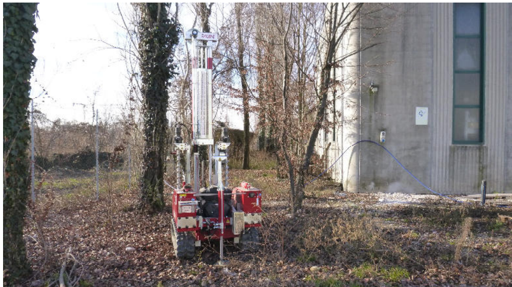
Foto 1: Esecuzione prova DPSH1
