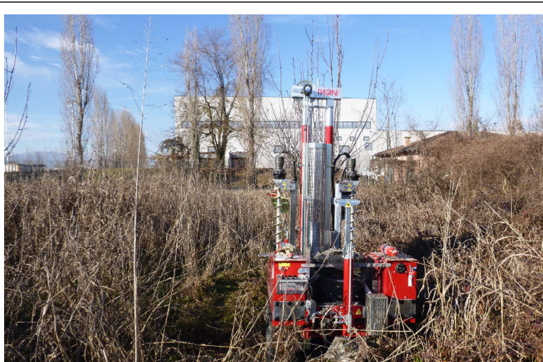
Foto 8: Esecuzione prova DPSH8
