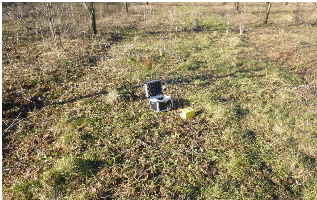
Foto 9: Esecuzione indagine sismica passiva a stazione singola T1
