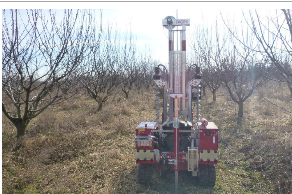
Foto 4: Esecuzione prova DPSH4
