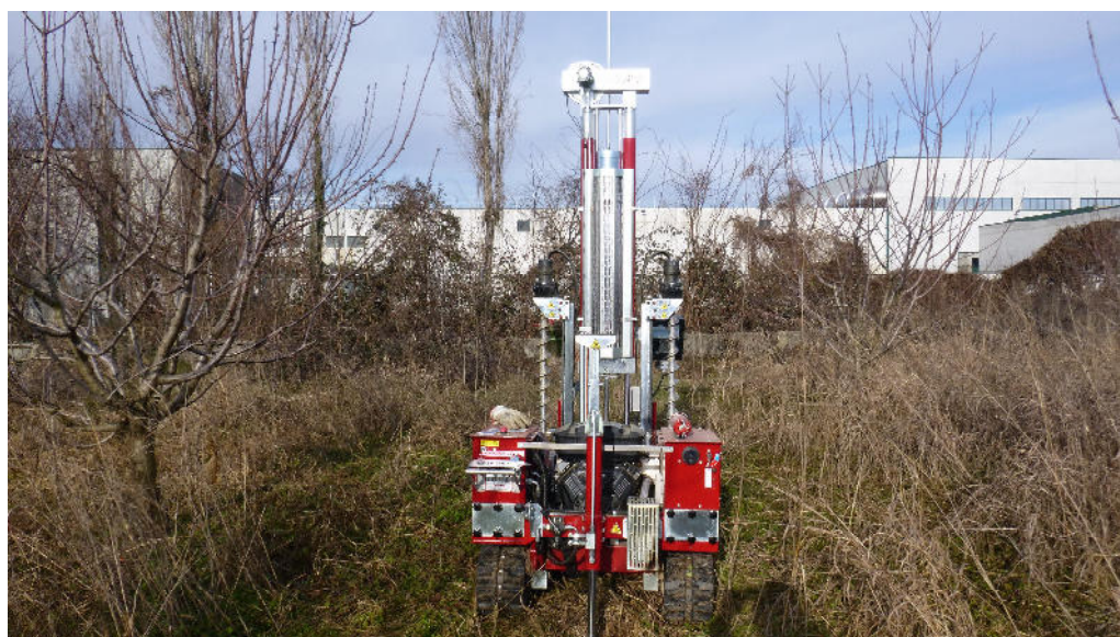
Foto 3: Esecuzione prova DPSH3
