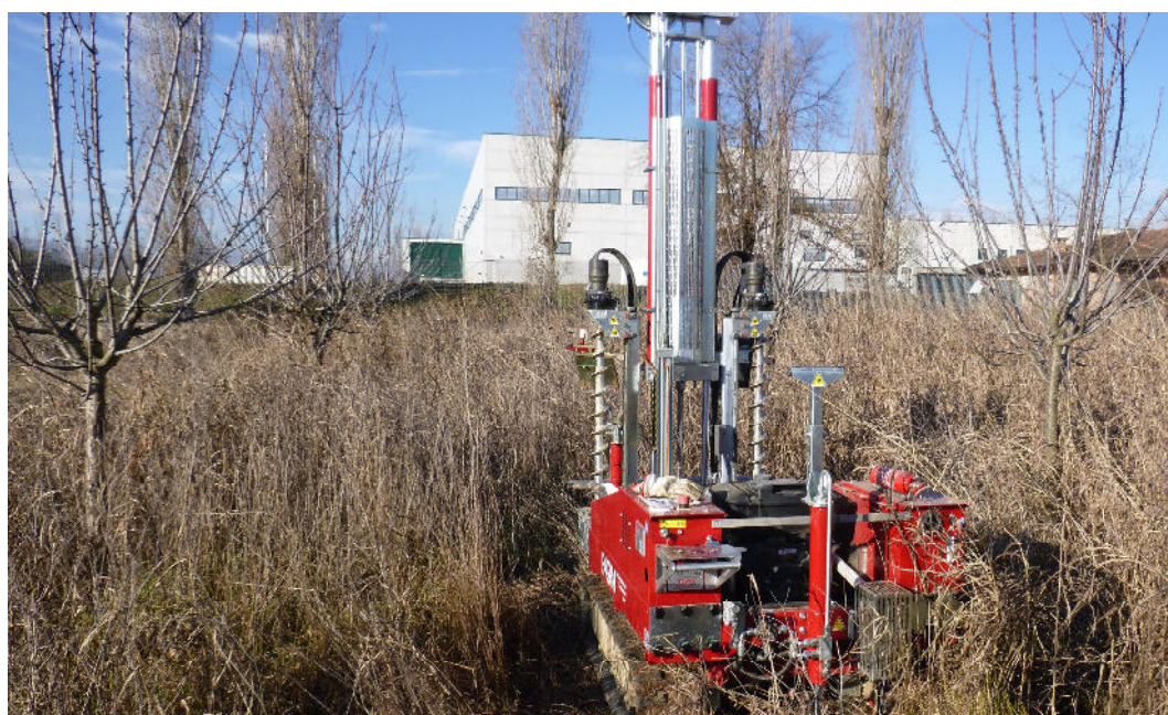
Foto 7: Esecuzione prova DPSH7
