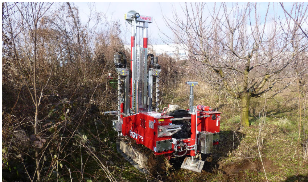
Foto 6: Esecuzione prova DPSH6
