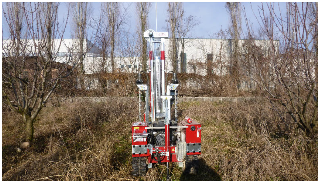
Foto 2: Esecuzione prova DPSH2
