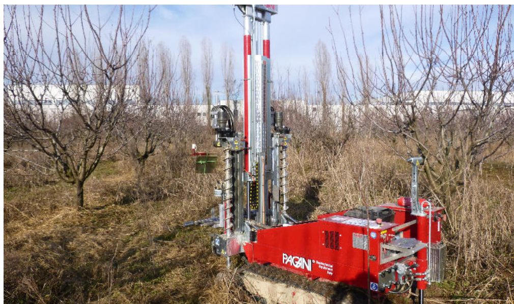
Foto 5: Esecuzione prova CPT5
