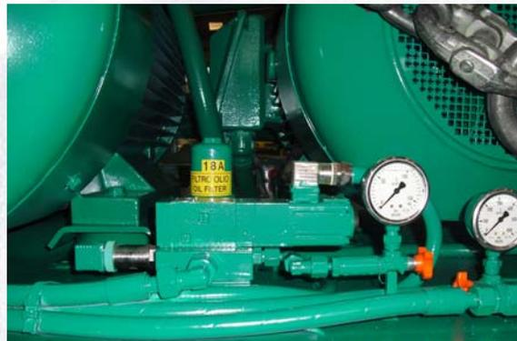
E' costituito da una valvola idraulica proporzionale gestita dal sistema pannello operatore MSS1 o MSS2 che regola automaticamente la pressione di lavoro in base al materiale selezionato.
