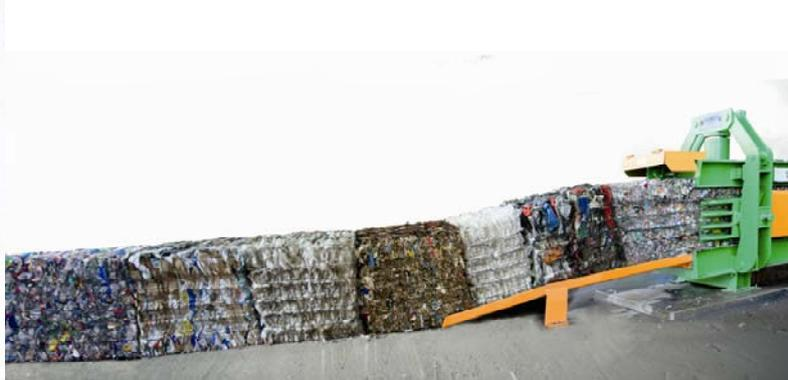
Il sistema **MDC** (Mac Density Control) consente di controllare la pressione di lavoro della pressa in modo ideale e rapido, per ottenere balle omogenee e della massima densità per ogni tipo di materiale imballato.
