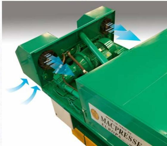
La cabina di insonorizzazione ha una duplice funzione, quella di ridurre il livello di rumorosità prodotto dalla centrale idraulica per conformarsi alla normativa vigente, ed al tempo stesso quella di proteggere dalla polvere motori elettrici e pompe idrauliche.
