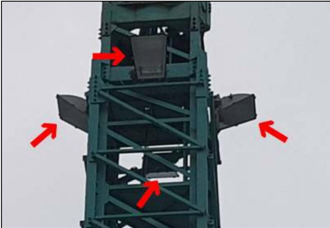
*Foto 1: lampade installate nella gru dell'impianto di vagliatura*
