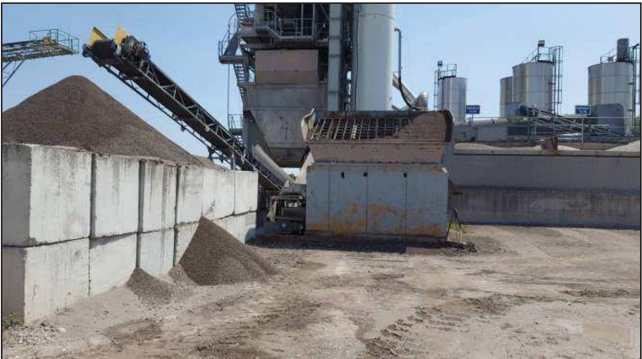
*Foto 4: Tramoggia di carico linea di lavorazione (vagliatura e frantumazione)*
