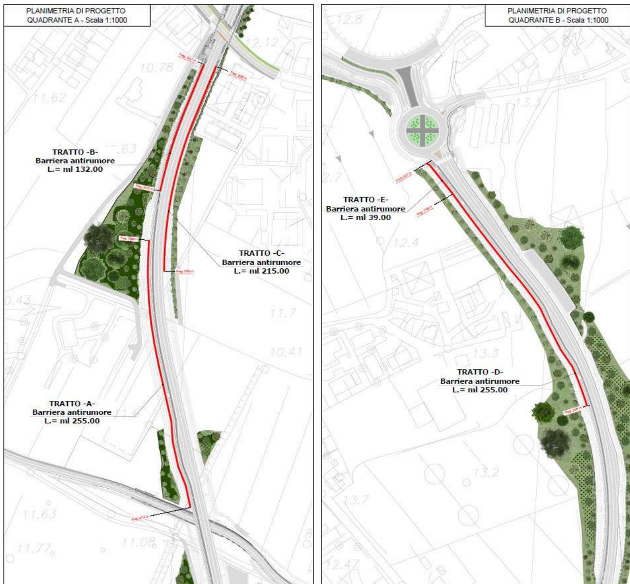
Figura 15-10: Stralcio planimetrica di progetto opere di mitigazione acustica – Progetto Definitivo
