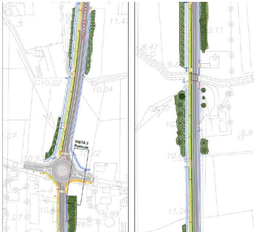
Figura 15-3- Soluzioni progettuali – parte a sud del tracciato – asse viario oggetto di allargamento sul fronte ovest
