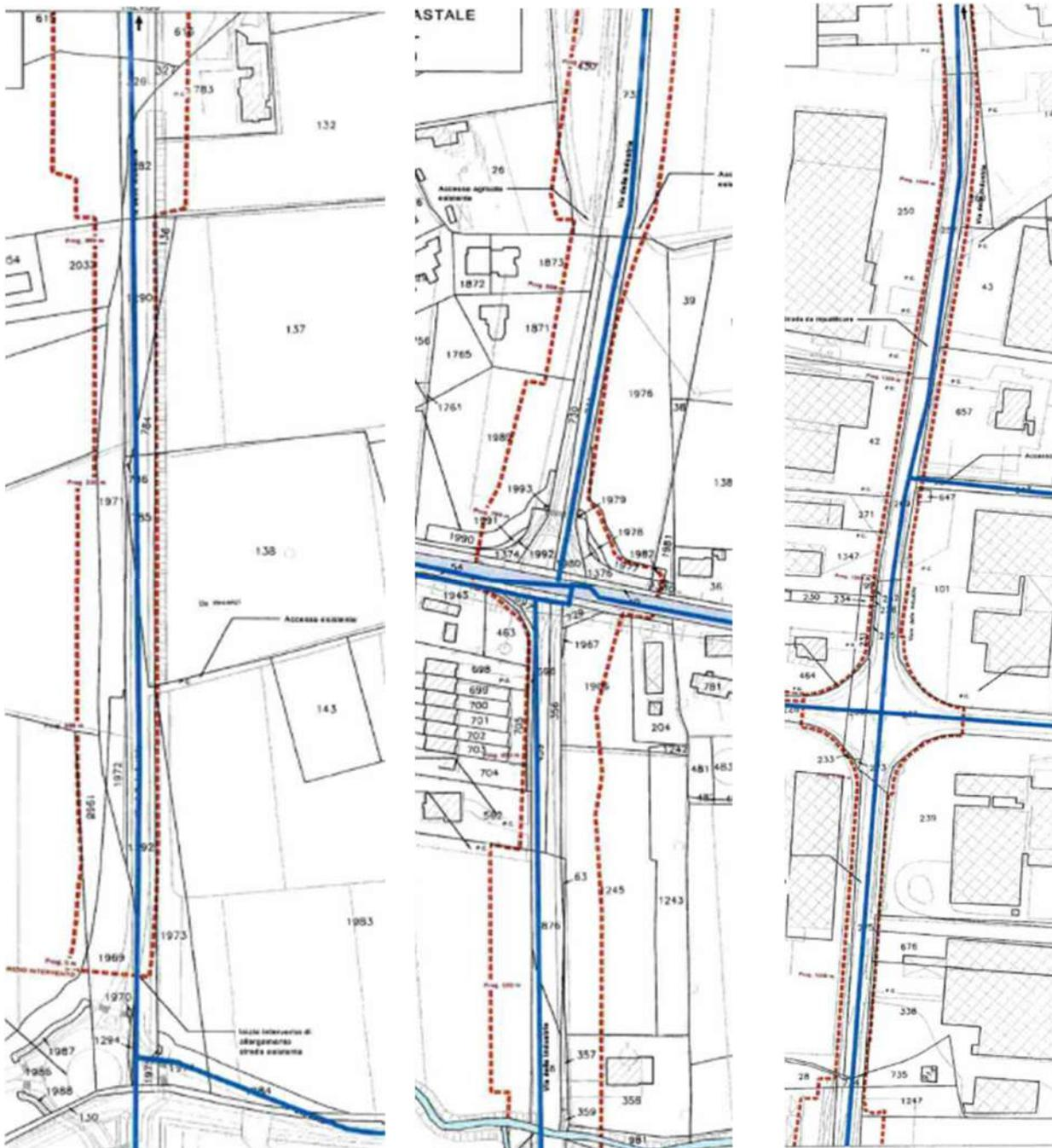
Figura 30 – Condotta di adduzione in fibrocemento presente nel tratto di riqualifica di Viale delle Industriale da Via Alta alla Zona Industriale di Casier (linea blu).
