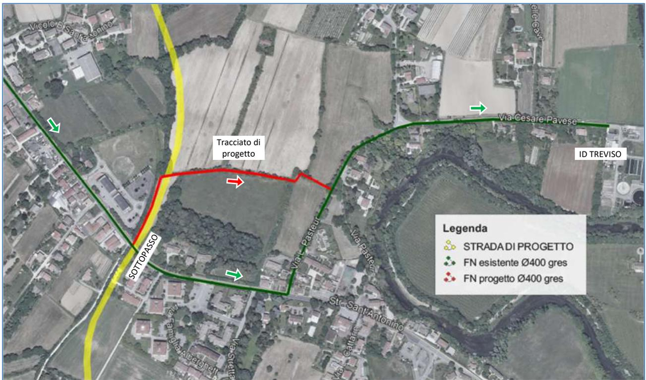
Figura 23 – Risoluzione della interferenza linea FN in via Sant'Antonino (Nuovo tracciato in rosso).
