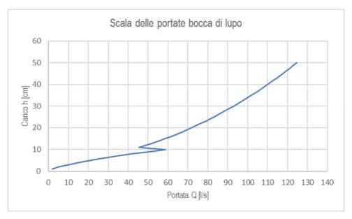
Figura 11: Scala delle portate di una caditoia di luce L=1,50 m, con bocca a gola orizzontale di altezza z=0,10 m.
