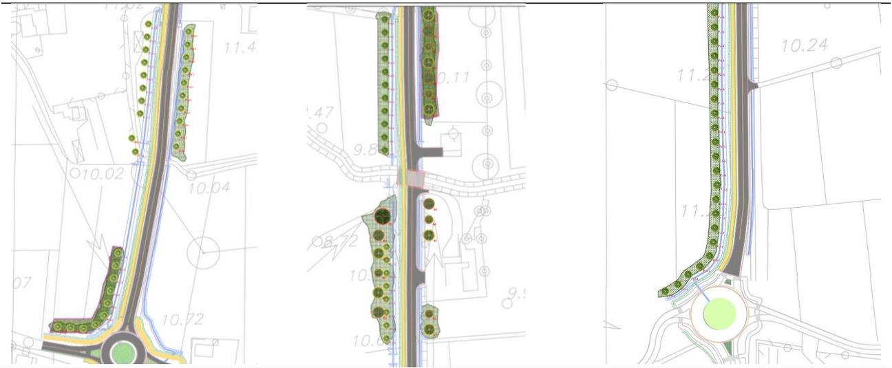
Figura 5-3- Soluzioni progettuali – parte a sud del tracciato – asse viario oggetto di allargamento sul fronte ovest
