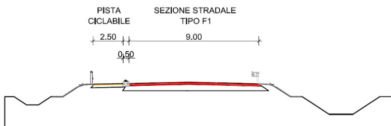
Figura 4-8- Sezione tipologica tra via alta e via della Liberazione
