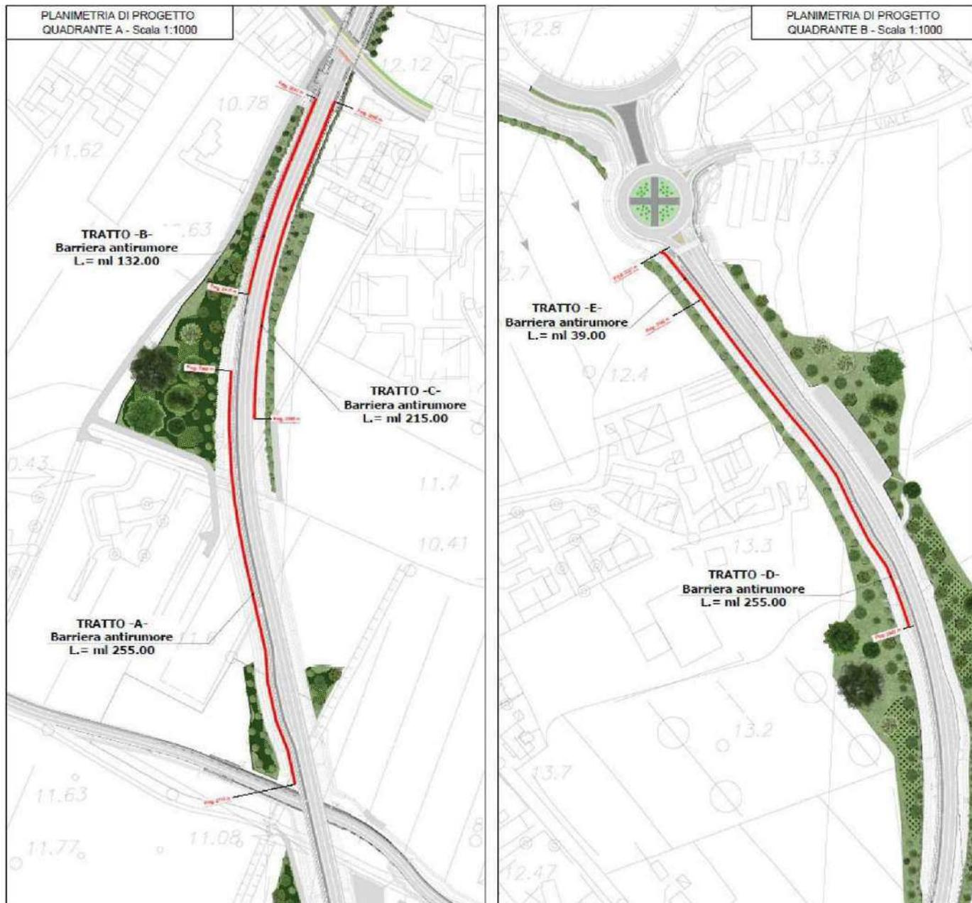
Figura 15-10: Stralcio planimetrica di progetto opere di mitigazione acustica – Progetto Definitivo
