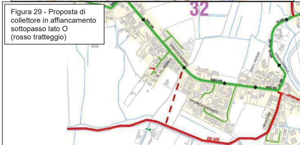
Infine per quanto riguarda la linea di FB, essa verrà interrotta in corrispondenza al nuovo sottopasso. La parte intercettata di monte verrà deviata all'interno dei nuovi fossati perimetrali al sottopasso e quindi scaricata verso S in direzione dello scolo Fuin, attuale recapito delle acque meteoriche.
