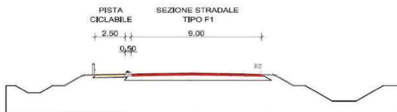
Figura 8 - Sezione tipologica tra via alta e via della Liberazione
