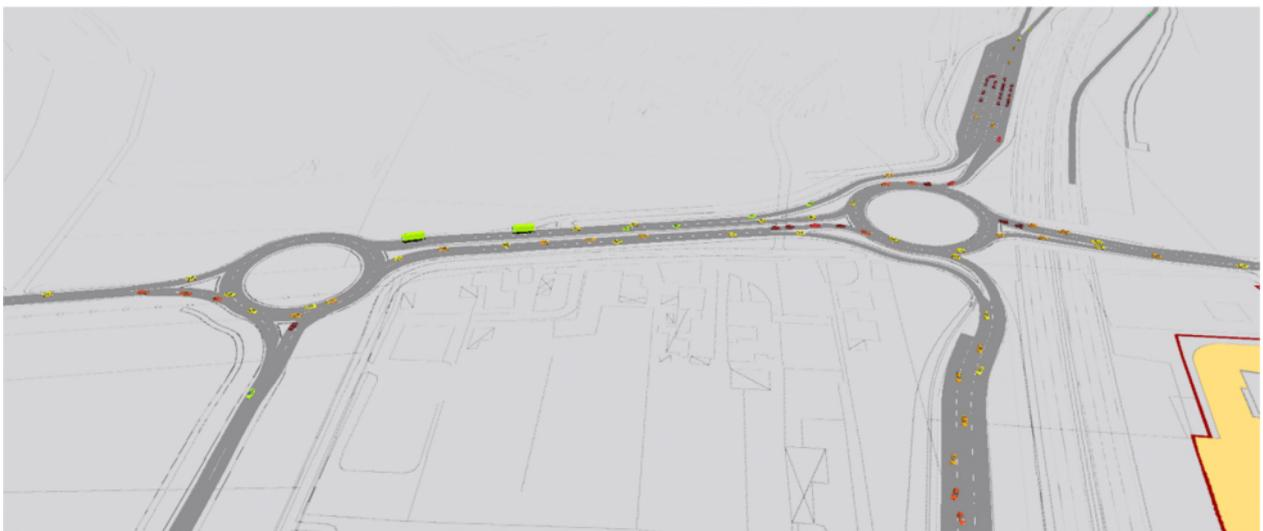
Figura 33 – Rete microsimulata 3d – dettaglio rotonde di progetto lungo la SR348 "Feltrina"
