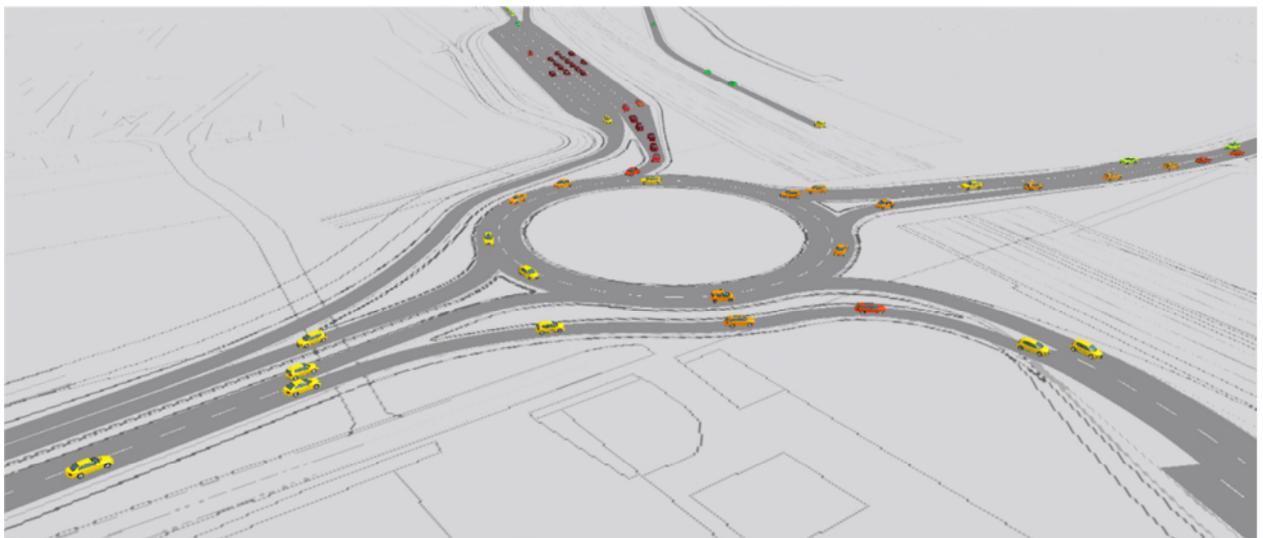
Figura 32 – Rete microsimulata 3d – dettaglio casello autostradale e rotonda limitrofa
