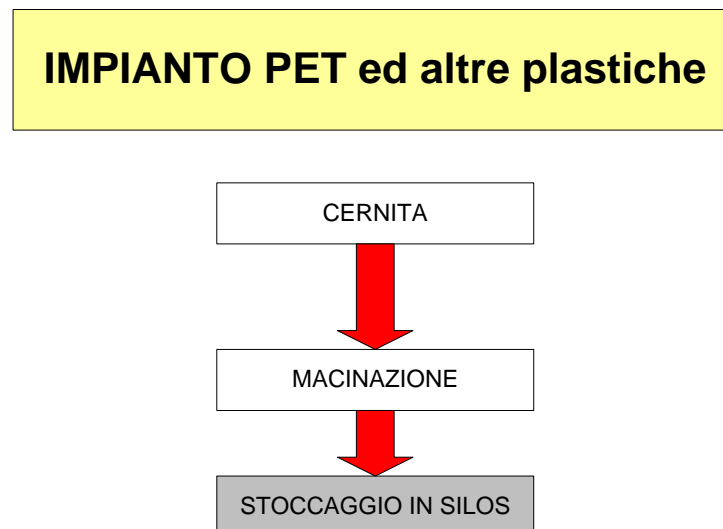
Figura 2.11. Diagramma di flusso del processo di recupero del PET ed altre plastiche
