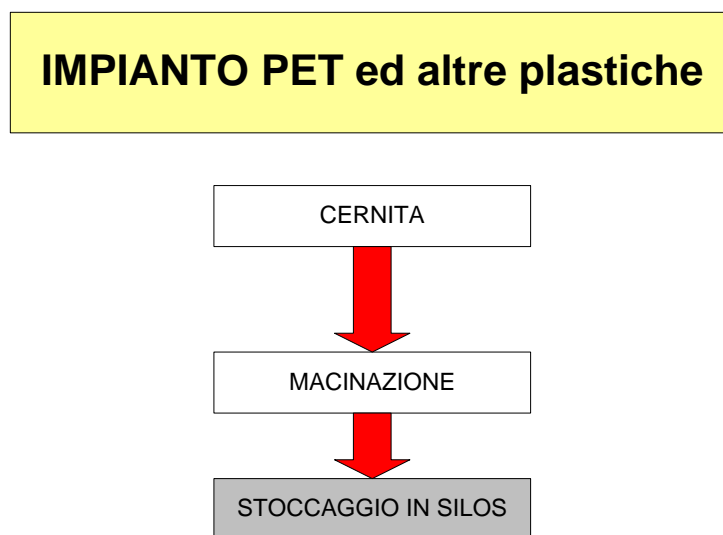
Figura 3.11. Diagramma di flusso del processo di recupero del PET ed altre plastiche
