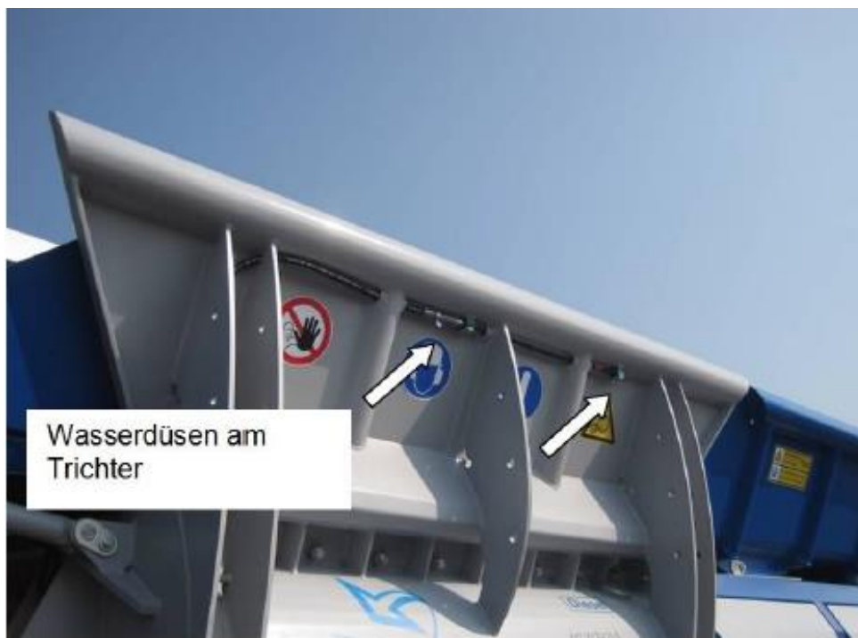
Figura XXIV - Individuazione del sistema idraulico a supporto degli abbattitori (foto di archivio Lindner).
