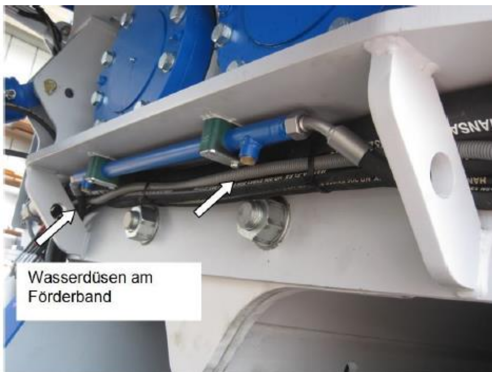
Figura XXV - Dettagli del sistema idraulico a supporto degli abbattitori (foto di archivio Lindner).
